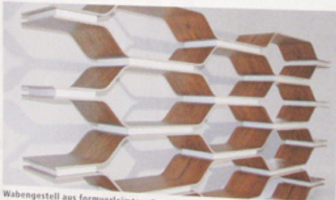
Wabengestell aus formverleimtem Sperrholz. Tischlermeister Guggenbichler.
